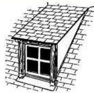
lucarne rampante ou en chien couché
