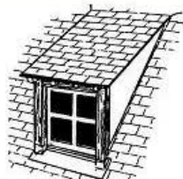
lucarne rampante ou en chien couché
